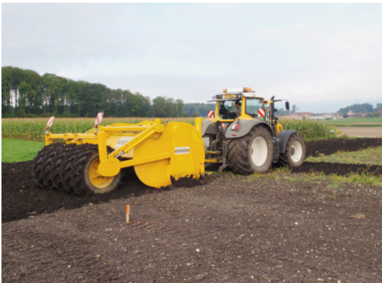
Die Tiefenrotationsspate vermischt im Täuffeler Moos die mit Torf überschüttete Fläche mit dem gewachsenen und belebten Oberboden. Nur so bleibt das Land auch längerfristig fruchtbar.
